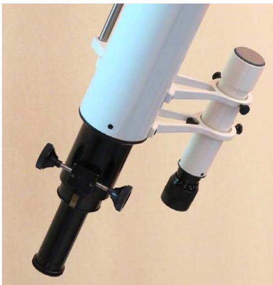
Links: Der Okularauszug und das Sucherfernrohr, rechts: Laufgewicht mit Feder und Schraube
