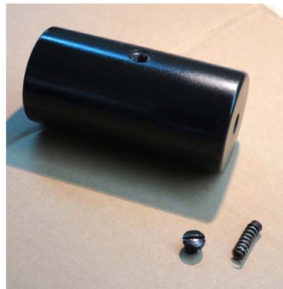
Links: Der Okularauszug und das Sucherfernrohr, rechts: Laufgewicht mit Feder und Schraube
