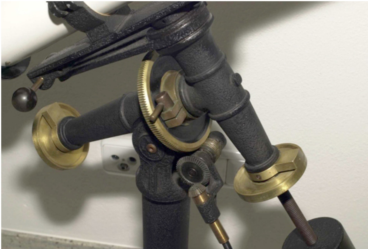
Abbildung 12: Das Tischstativ „C“ für das Schulfernrohr „E 68“ verfügte über Feinbewegungsmechanismen in beiden Achsen.
