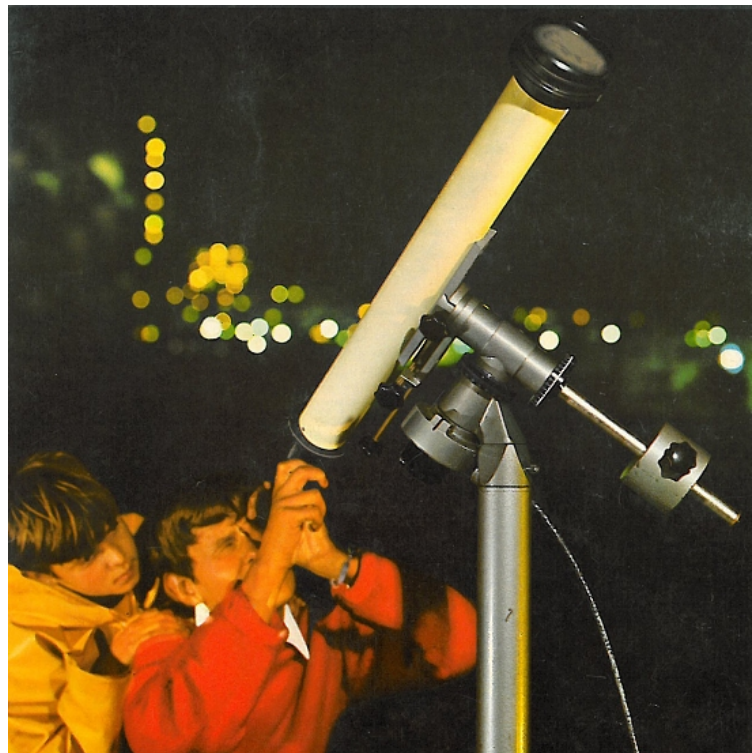
Abbildung 17 (links): Die Orion 1 Montierung stammt aus der Wachter'schen Werkstatt und wurde von Kosmos zwischen 1965 bis 1972 in der hier abgebildeten Version mit gekapseltem Schneckengetriebe geliefert. Quelle: Werbeprospekt Fa. Kosmos (Astro-Fibel aus dem Jahre 1967).
