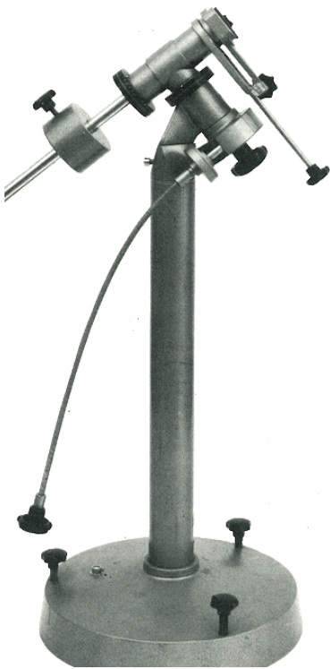
Abbildung 17 (links): Die Orion 1 Montierung stammt aus der Wachter'schen Werkstatt und wurde von Kosmos zwischen 1965 bis 1972 in der hier abgebildeten Version mit gekapseltem Schneckengetriebe geliefert. Quelle: Werbeprospekt Fa. Kosmos (Astro-Fibel aus dem Jahre 1967).
