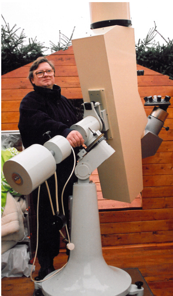
Abb. 11 (links): Ein 200/4000 mm Schaefer-Refraktor in gebrochener Bauweise „nach Wachter“. Das abgebildete Instrument besitzt einen Okularauszug mit einer lichten Weite von 140mm. Quelle: Foto Remmert
