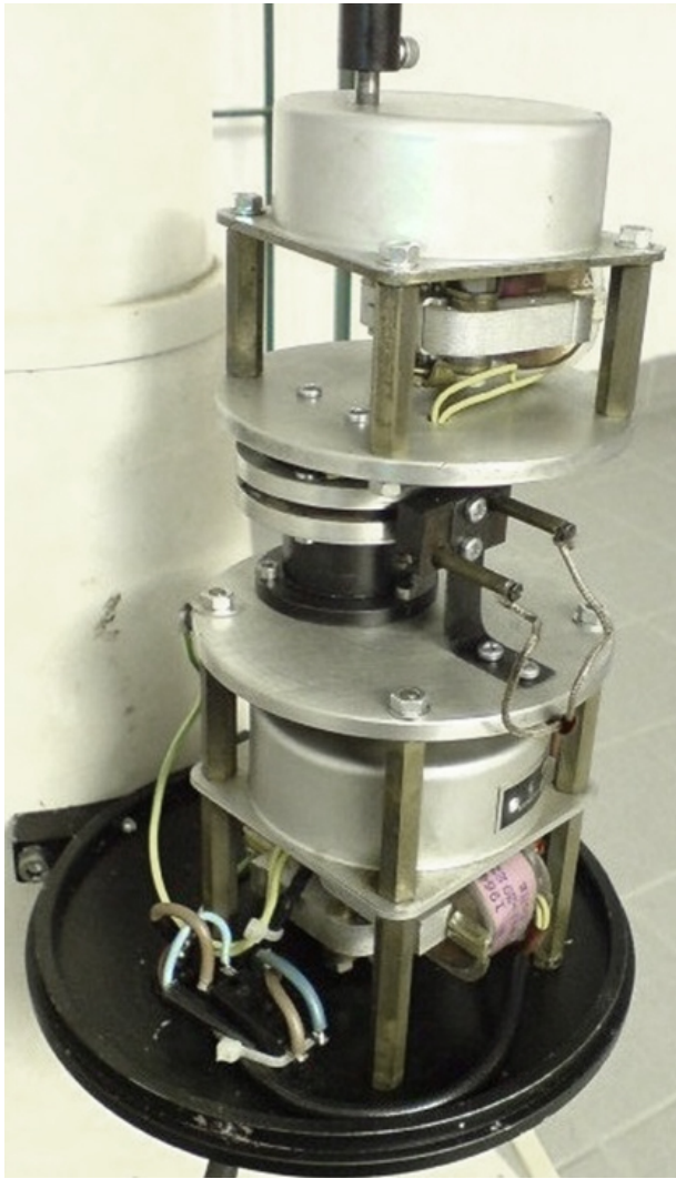
Abb. 05 (oben): Ein Blick in das offene Gehäuse zeigt das Nachführwerk der Montierung „III“. Das Antriebssystem bestand aus einem Synchronmotor mit 220 Volt/50 Hz Anschluss für die konstante Geschwindigkeit. Mittels Handtaster konnte ein Asynchronmotor zugeschaltet werden, der eine feinfühligte Korrektur in Rektaszension erlaubte. Quelle: Foto Felix Schmicker.
