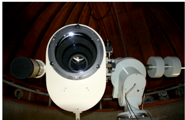
Abb. 25 a/b: 300/3900 mm Schaer-Refraktor der Sternwarte Violau. Das linke Foto zeigt die Gesamtansicht des kompletten Fernrohres. Die rechte Abbildung gibt den Blick auf das halbapochromatische 30 cm Objektiv sowie auf den ersten Planspiegel im hinteren Rohrkörper frei. Quelle: Fotos v. Christoph Mayer, Leiter der Sternwarte Violau.
