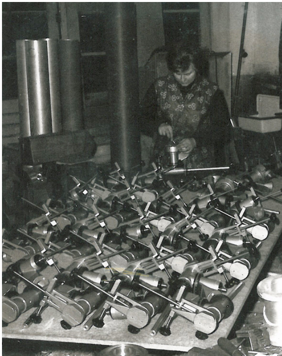
Abb. 13: Serienherstellung der Montierung „I“ in der Wachter'schen Werkstatt in Stuttgart – Uhlbach im Jahre 1966. Quelle: Privatfoto Familie Wachter
