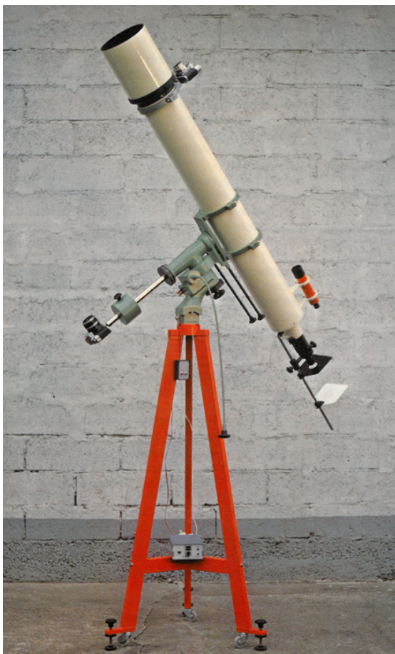
Abb. 35: 150/1500mm Refraktor in kompletter Ausstattung mit Montierung ASTRONOM „II“ und Pyramidenstativ (gefertigt von 1976 bis 1984). Quelle: Wachter Faltprospekt, 1978.
