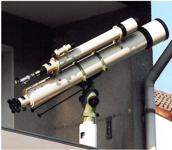
Abb. 32 (oben) : 150 mm Refraktor aus dem Jahre 1980 mit 80 mm Leitfernrohr und Montierung Astronom „II“ auf Balkonsternwarte. Quelle: Foto Remmert.
