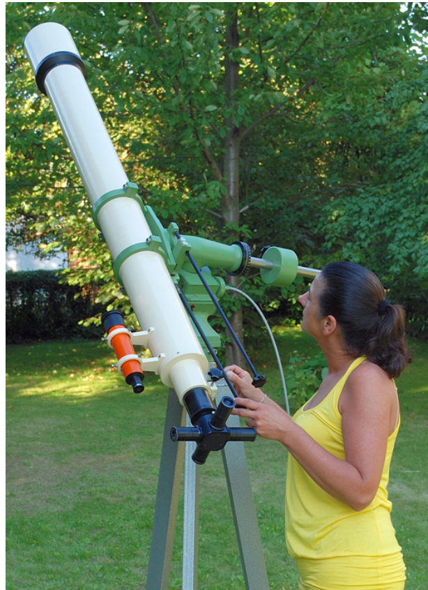
Abb. 32 (oben) : 150 mm Refraktor aus dem Jahre 1980 mit 80 mm Leitfernrohr und Montierung Astronom „II“ auf Balkonsternwarte. Quelle: Foto Remmert.
