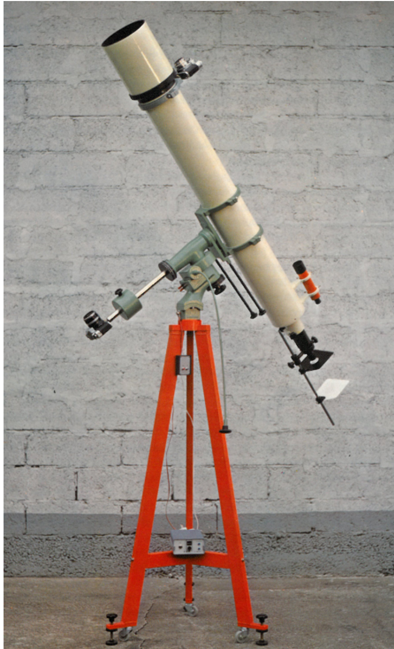
150/1500mm Refraktor in kompletter Ausstattung mit Montierung ASTRONOM „II“ und Pyramidenstativ, gefertigt von 1976 bis 1984
