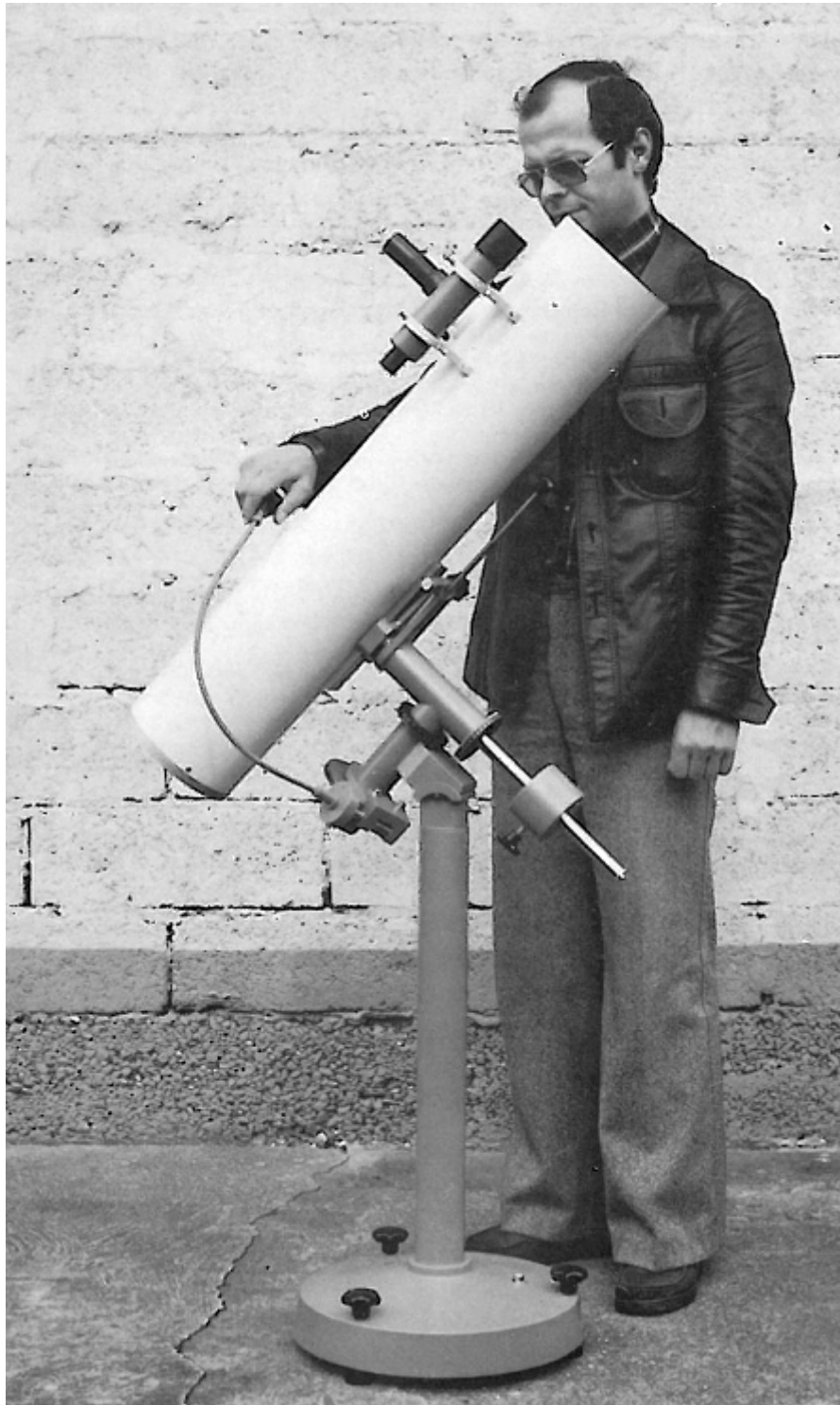
Abb. 31: 150 / 900 mm Newton, auf ASTRONOM „I“ und kleiner Rundsäule. Quelle: aus Faltprospekt Wachter, 1978
