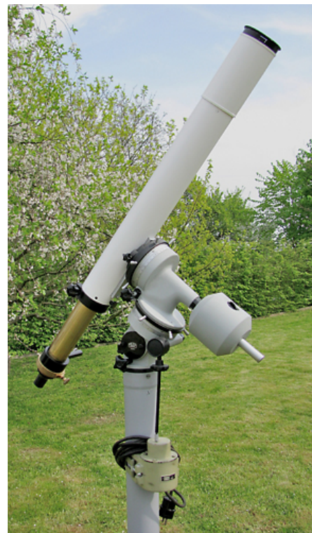
Abbildung 2: Schulfernrohr 63/840, erstes Modell, mit angeflanschem Synchronmotor an der Säule
