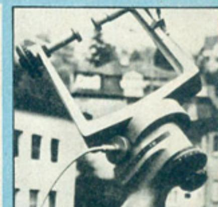
Das beste Fernrohr kann auf einer schlechten Montierung nichts leisten. Das Schiefspiegler-Fernrohr (links) ist auf einer stabilen Orion-5-Montierung (oben) befestigt. Es hat einen Motor eingebaut, der dafür sorgt, daß der einmal anvisierte Himmelskörper ständig im Blickfeld bleibt.
