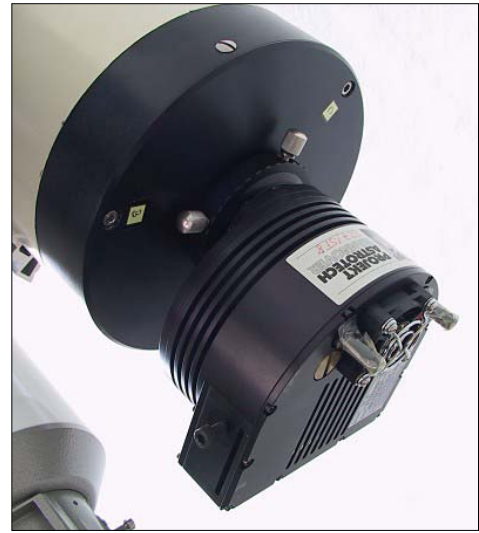
Abbildung 19 und 20: Links der Baader Adapter mit dem 1 1/4" Ceshire Justierokular, rechts eine SBIG CCD-Kamera in der 2 Zoll Aufnahme
